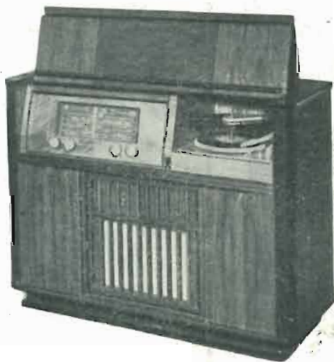
FI. 840 A. "Gran Concerto", radiofonografo di lusso; 15 valvole "Noval" e "Miniatura" piú occhio magico; 8 gamme d'onda di cui una a modulazione di frequenza; cambiadischi a 3 velocità; a richiesta può essere fornito con magnetofono PHILIPS.
