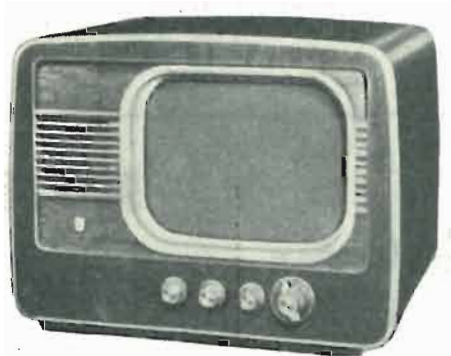
TX 1421 A/68. Intercarrier; quadro da 14 pollici; 21 valvole serie speciale per TV.; tutti i canali italiani.
