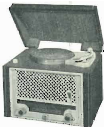
HI. 434 A. Radiofonografo da tavolo; 5 valvole "Rimlock" piú indicatore di sintonia; onde medie e corte; regolatore di tono; giradischi a 3 velocità.
